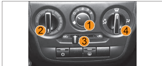
Рис. 37. Блок управления системой вентиляции и отопления
