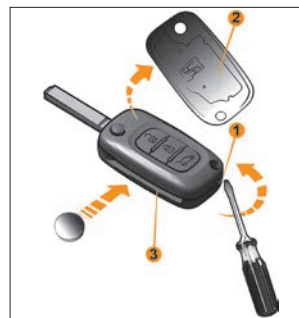
Рис. 52. Замена элемента питания пульта дистанционного управления
