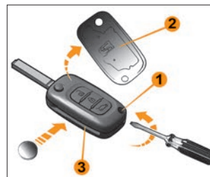
Рис. 52. Замена элемента питания пульта дистанционного управления
