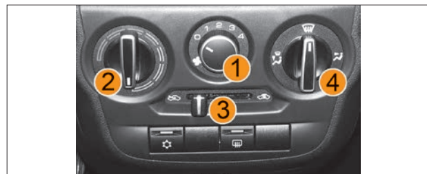
Рис. 37. Блок управления системой вентиляции и отопления (в варианном исполнении)
