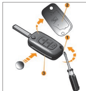
Рис. 52. Замена элемента питания пульта дистанционного управления
