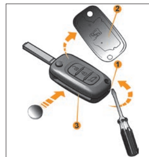
Рис. 52. Замена элемента питания пульта дистанционного управления
