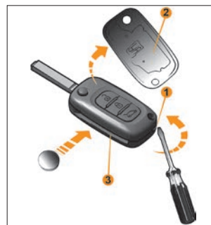
Рис. 52. Замена элемента питания пульта дистанционного управления
