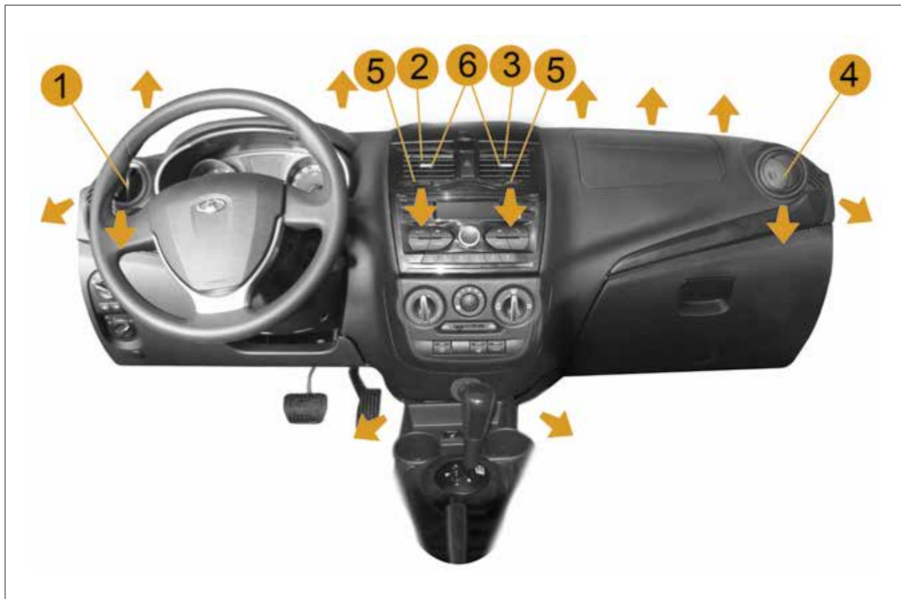
Рис. 38а. Направления потоков воздуха из дефлекторов
