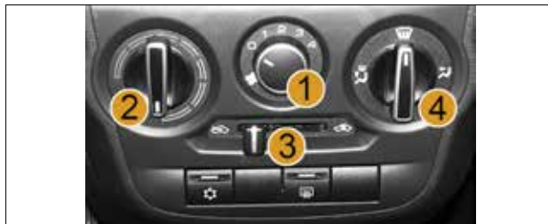
Рис. 37. Блок управления системой вентиляции и отопления
